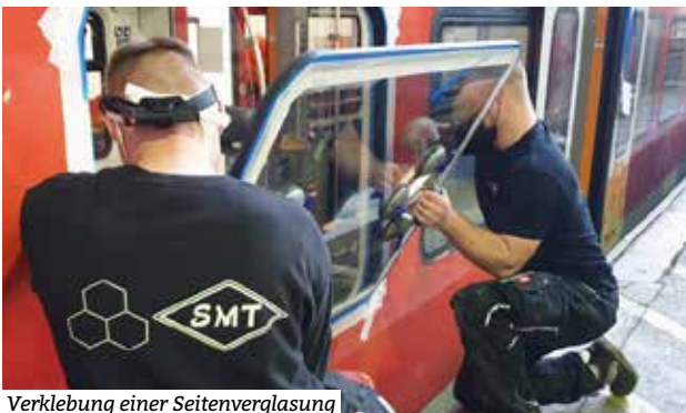
Verklebung einer Seitenverglasung
